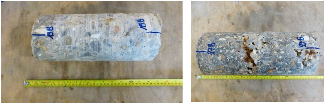
FIGURE 4: Aspect visuel de quelques carottes de béton : À gauche, aspect visuel et sain. À droite, aspect sain, mais avec des vides de taille conséquente.
